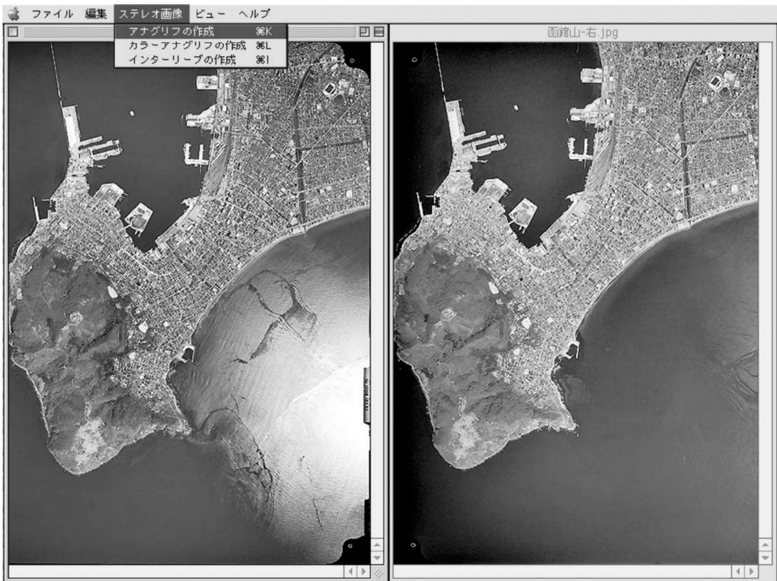
図2 専用ソフトウェアによるステレオペア写真からのアナグリフ画像作製操作の画面
