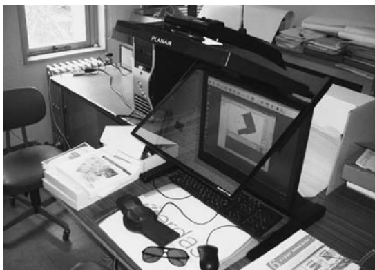
図2 ステレオスコピックモニターの例 PLANAR社SD2020. 20インチ液晶モニターが上下に2枚あって左右のステレオ画像をそれぞれ表示し、間にあるハーフミラーで合成された画像を偏光めがねで実体視する。
